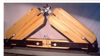
Образец для испытания соединений на металлических пластинах и дюбелях с зубчатыми шайбами
